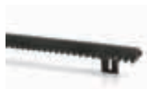
ROA6 CRÉMAILLÈRE M4 25x20x1000 mm AVEC PERFORATIONS EN NYLON ET ARMATURE MÉTALLIQUE. POUR PORTAILS D'UN POIDS MAX. DE 500 kg. P.CES/EMB. 10
