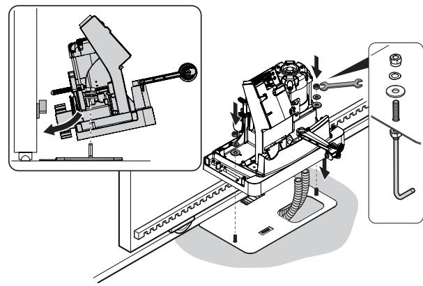
f - Zkontrolujte správné umístění elektropřevodovky na základové desce
