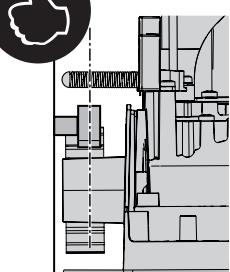
k - Zkontrolujte, zda je vzdálenost mezi pastorkem a ozubenou tyčí 1 až 2 mm. Pokud tomu tak není, upravte výšku motoru přitažením stavěcích šroubů, aby ste zabránili tomu, že váha křídla bude spočívat na elektropřevodovce
