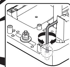
l - Křídlo posouvajte manuálně a pomocí pastorku jako reference připevněte ostatní části ozubené tyče
