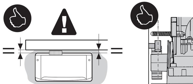
k - Проверьте, чтобы зазор между шестерней и зубчатой рейкой был равен примерно 1 ч 2 мм. В противном случае во избежание воздействия веса ворот на электропривод, отрегулируйте высоту электропривода с помощью регулировочных винтов без головок
