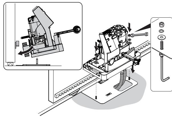
f - Proverite da li je elektromotor s reduktorom pravilno postavljen na temeljnoj ploči
