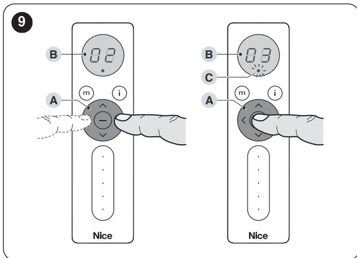
Une fois le groupe souhaité sélectionné, il est possible d'envoyer une commande (montée/ouverture « ^ », stop « - » ou descente/fermeture « v »). Lorsque la commande est envoyée, la LED (C) du groupe sélectionné clignote en **ORANGE** et après quelques instants (le temps d'envoi de la réponse de l'automatisme), elle indique le résultat de la commande :
