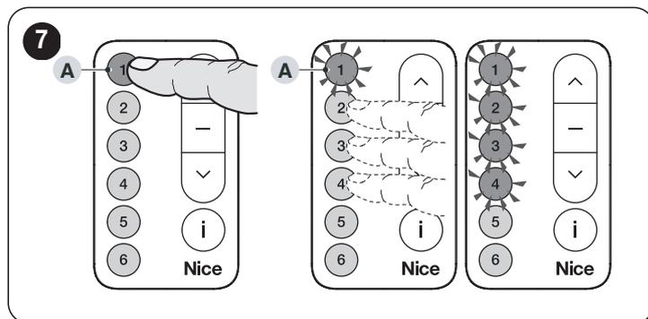
Une fois le groupe souhaité sélectionné, il est possible d'envoyer une commande (montée/ouverture « ^ », stop « - » ou descente/fermeture « v »). Lorsque la commande est envoyée, la LED du groupe sélectionné clignote en **ORANGE** et après quelques instants (le temps d'envoi de la réponse de l'automatisme), il indique le résultat de la commande (Figure 8) :
