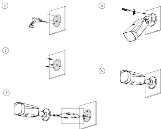
Рис. 3.3 А - Прохождение кабеля через монтажную поверхность
