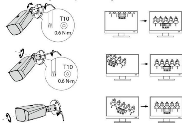
Рис. 3.5 Регулировка угла наклона объектива
