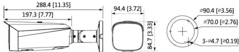
Рис. 3-1 Габаритные размеры (единицы измерения: мм [дюймы])
