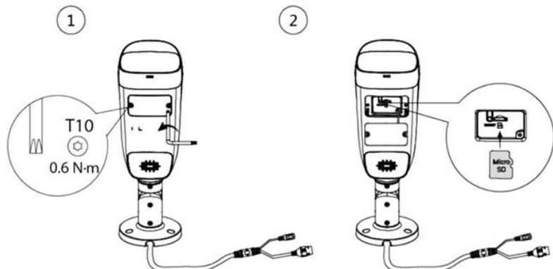
Рис. 3-2 Установка SD-карты (единицы измерения: мм [дюймы])
