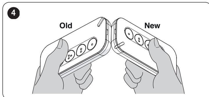
2. Sul NUOVO trasmettitore (New), tenere premuto un tasto qualsiasi fino a quando il led (A) del VECCHIO trasmettitore (Old) si accende. Quindi, rilasciare il tasto (il led (A) del VECCHIO trasmettitore (Old) inizia a lampeggiare).
