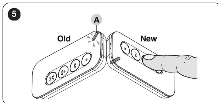
3. Sul VECCHIO trasmettitore (Old), tenere premuto un tasto qualsiasi fino a quando il led (B) del NUOVO trasmettitore (New) si accende. Quindi, rilasciare il tasto (il led (B) del NUOVO trasmettitore (New) si spegne, segnalando il termine della procedura e l'avvenuto trasferimento del "codice di abilitazione" nel NUOVO trasmettitore).
