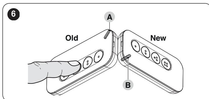
Nel caso di errore il led (A) indicherà il tipo di errore con dei lampeggi:
