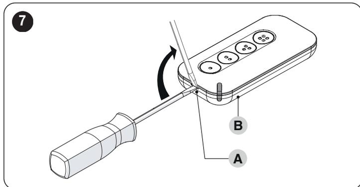
2. premere la batteria nel punto (1) e applicare una torsione del guscio (B) per sbloccare la batteria dal gancio di tenuta (2) e poterla così rimuovere
