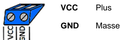
Fig.4: Raccordement à l'alimentation en tension (bleu)
