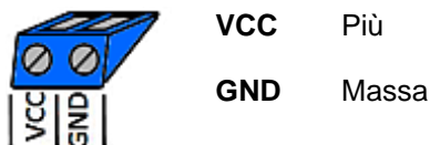
Fig.2: Alimentazione di tensione (blu)
