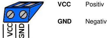
Abb. 2: Beispiel Spannungsversorgung (blau)
