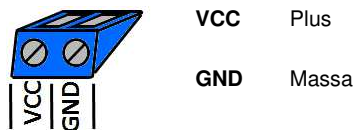
Afb. 2: Voorbeeld spanningsvoorziening (blauw)
