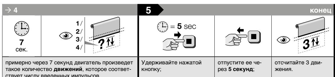
(\*) – **ВАЖНАЯ ИНФОРМАЦИЯ** – Сразу же после программирования этой функции или после восстановления электропитания (если имел место сбой электропитания) для ее активации **необходимо выполнить 2 полных цикла перемещений** (подъем и опускание = 1 цикл). В ходе этих перемещений двигатель составляет карту мгновенных нагрузок в каждой точке хода шторы и автоматически задает чувствительность, максимально возможную с учетом характеристик установленной шторы.
