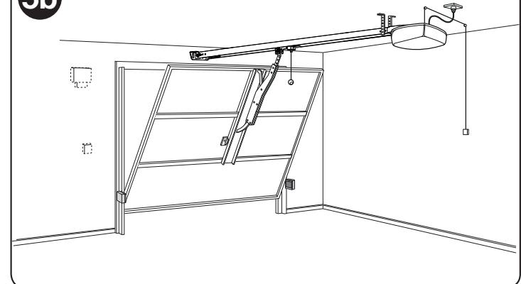
Pred zahájením inštalácie skontrolujte vonkajšie rozmery elektroprevodovky (**obr. 2**). Keď sú dvere, ktoré je potrebné zautomatizovať, výklopné, skontrolujte rozmer E, uvedený na **obr. 3**, t.j. minimálnu vzdialenosť medzi hornou stranou vedenia a maximálnym bodom, dosiahnutým horným okrajom dverí. V opačnom prípade nie je možné výrobok rady SPIN nainštalovať.
