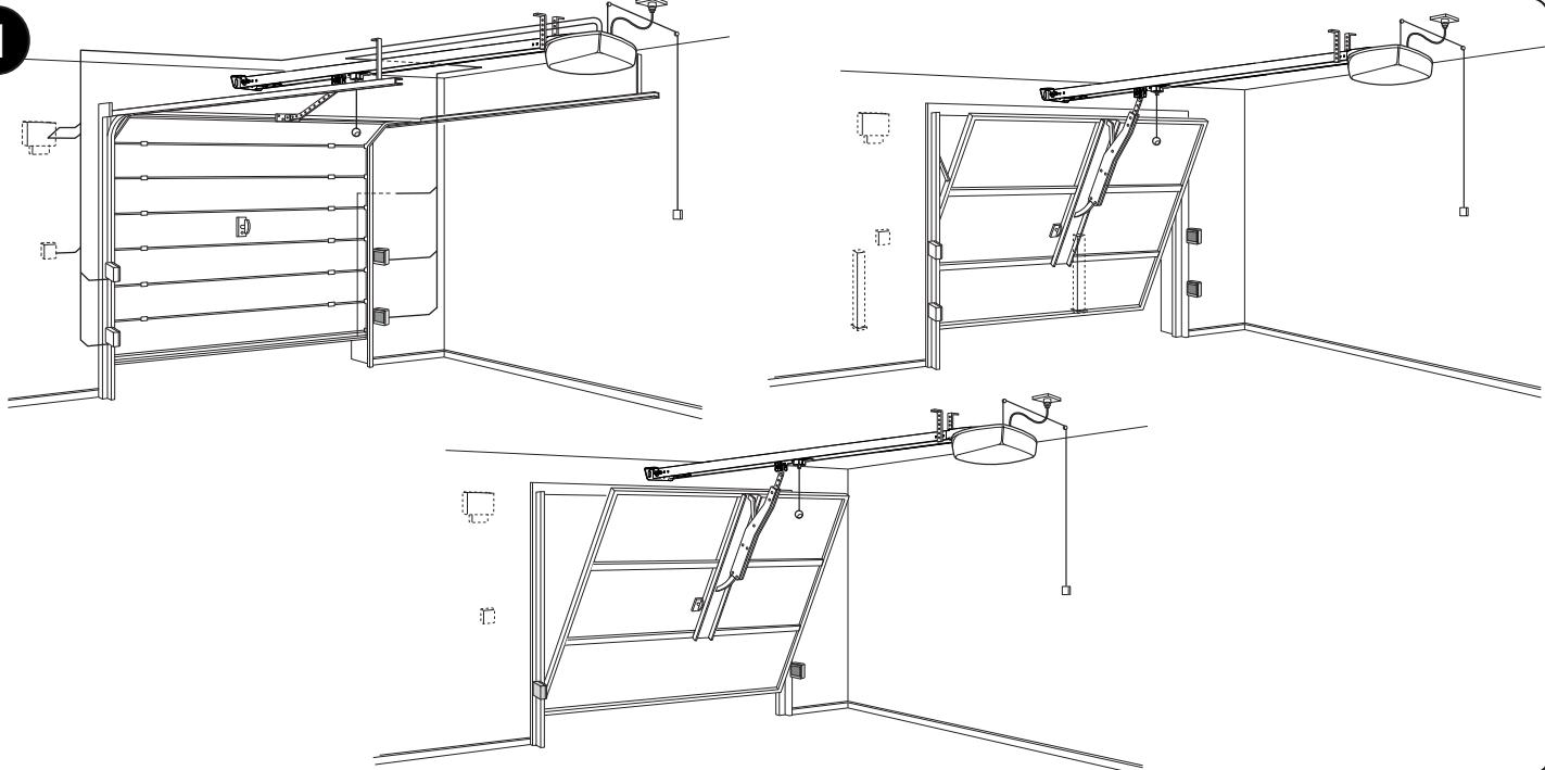
Rozmery uvedené v tabuľke 2 sú len orientačné a slúžia len pre základné zhodnotenie vhodnosti. Reálna vhodnosť výrobkov rady SPIN pre automatizáciu príslušných dverí závisí od mieri vyváženia krídla dverí, od trenia vedenia a od javov, vrátane náhodných, ako je sila vetra alebo prítomnosť ľadu, ktoré by mohli brániť pohybu krídla.
