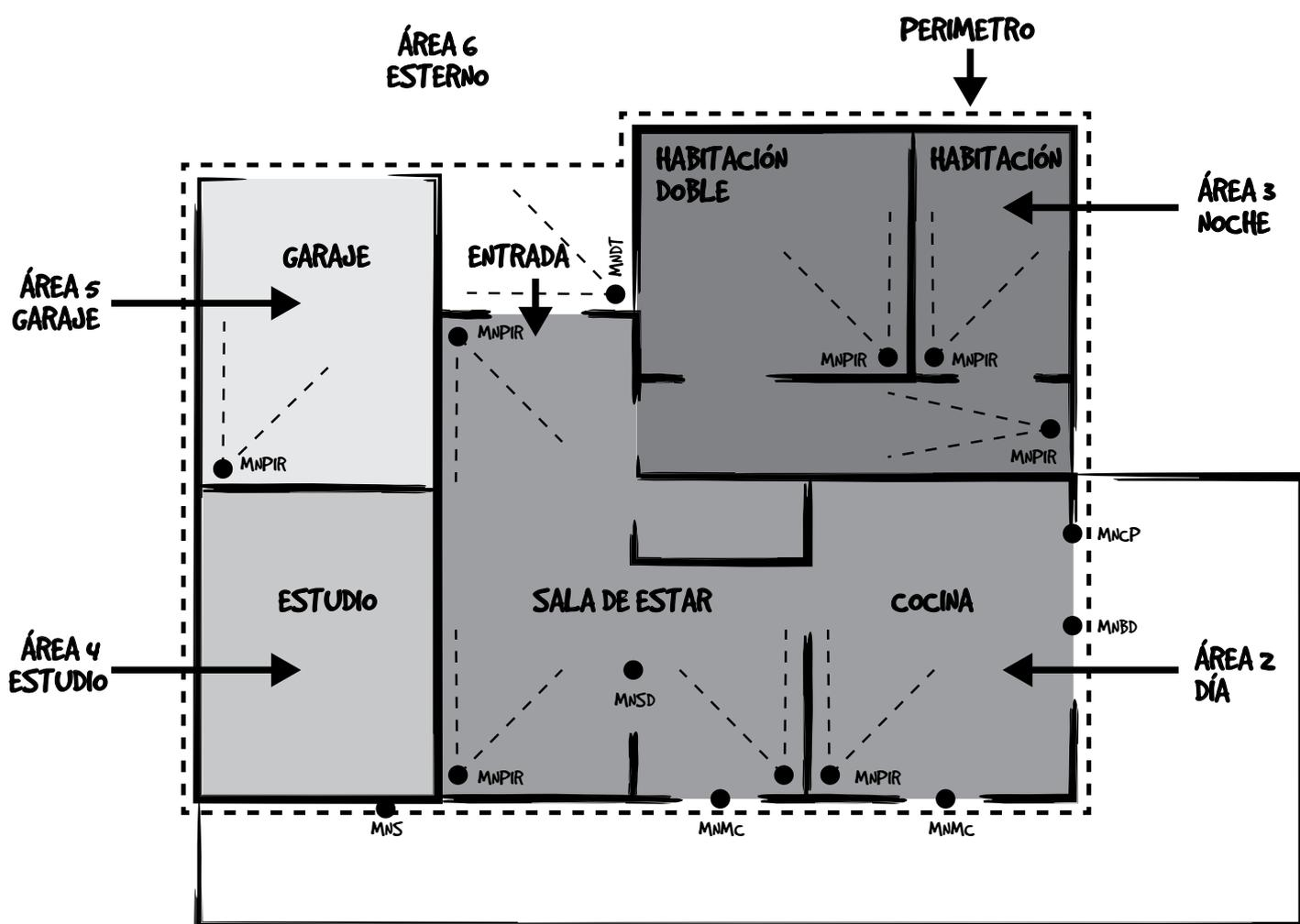
**Antes de la programación, dibujar la planimetría de los ambientes que se desea proteger e indicar los puntos exactos en los que se desea colocar los distintos dispositivos.**
